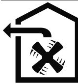
De lucht mag niet worden aangevoerd in een schoorsteen die wordt gebruikt voor afvoergassen van apparaten bestemd voor het verbranden van gas of andere brandstoffen (dit geldt niet voor ventilatieapparatuur).
