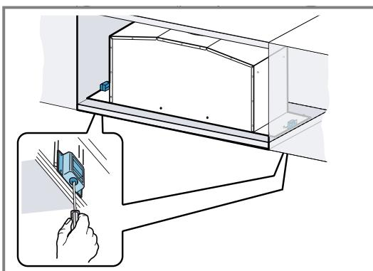
3. Den Rahmen anbringen und von unten mit dem Gerät verschrauben.
