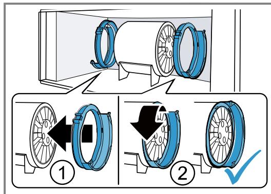
2. Insérer le filtre anti-odeurs dans les supports de fixation du filtre.
