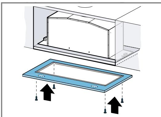
4. Den Rahmen und das Gerät mit Schrauben sichern.
