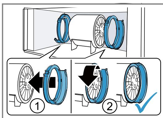
**2. De geurfilters in de filterhouders schuiven.**
