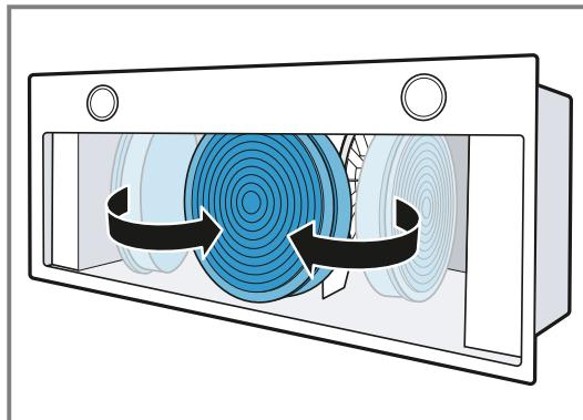
4. Het geurfilter verwijderen.
