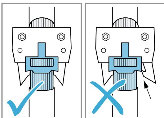
7. Insérez le filtre à graisse.
