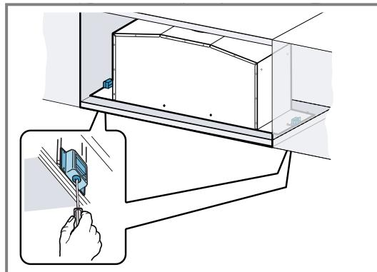
3. Mettre en place le cadre et le visser à l'appareil par le bas.
