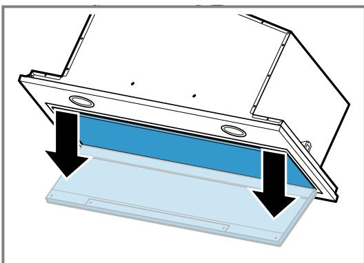
**3. De scharnierbeveiliging losmaken en de filterafdekking verwijderen.**
