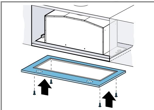
4. Het frame en het apparaat met schroeven borgen.
