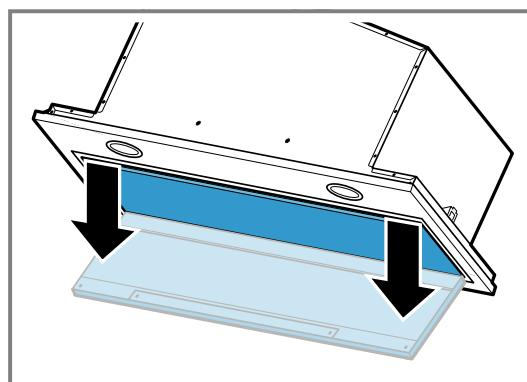
3. Die Scharniersicherung lösen und die Filterabdeckung entfernen.
