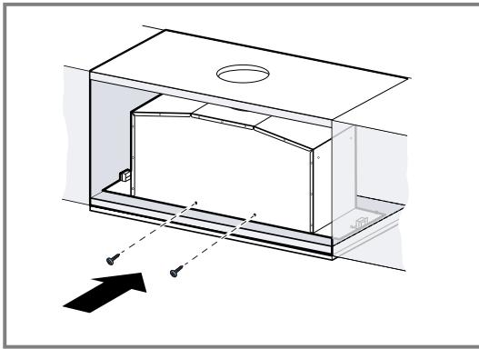
Wenn die Schrauben von außen nicht zugängig sind, können die Schrauben auch von innen montiert werden.
