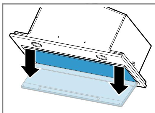
3. Démonter le dispositif de sécurité de la charnière et retirer le capot du filtre.
