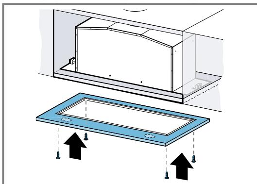
4. Fixer le cadre et l'appareil à l'aide de vis.
