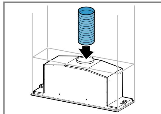
2. De verbinding met de afvoerluchtopening maken.
