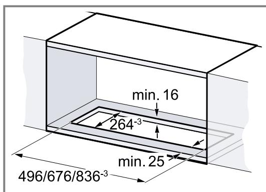
2. Réaliser la découpe pour le conduit d'évacuation d'air soit au-dessus du meuble d'encastrement, soit derrière le meuble d'encastrement.
