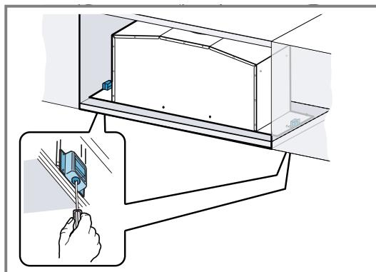
3. Het frame aanbrengen en van onderaf vastschroeven aan het apparaat.
