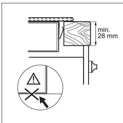
**i** Wird das Gerät über einer Schublade montiert, kann die Lüftung des Kochfelds die Gegenstände, die in der Schublade gelagert sind, während des Garvorgangs erwärmen.
