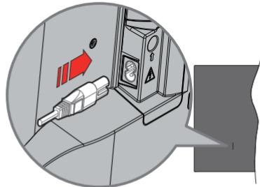
Jeden konec (zástrčka se dvěma otvory) dodaného odpojitelného napájecího kabelu zapojte do zásuvky pro napájecí kabel na zadní straně televizoru, jak je to znázorněno výše. Potom zapojte druhý konec napájecího kabelu do síťové zásuvky. Televizor se přepne do pohotovostního režimu.
