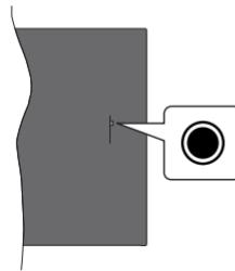
Váš televizor má jediné ovládací tlačítko. Tímto tlačítkem můžete ovládat funkce Vstupy / Zvyšování a snižování hlasitosti / Zvyšování a snižování kanálů / Zapnutí / vypnutí / Výstup z funkci TV.
