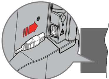
Συνδέστε το ένα άκρο (βύσμα δύο οπών) του παρεχόμενου αποσπώμενου καλωδίου ρεύματος στην είσοδο καλωδίου ρεύματος στην πίσω πλευρά της τηλεόρασης όπως φαίνεται παραπάνω. Στη συνέχεια συνδέστε το άλλο άκρο του καλωδίου ρεύματος στην πρίζα ρεύματος δικτύου. Η τηλεόραση θα μεταβεί σε κατάσταση αναμονής.
