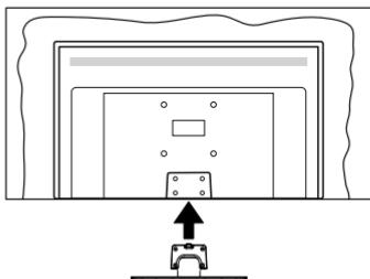
3. Poté vložte do otvorů čtyři dodané šrouby (M4 x 12 mm), jemně je utáhněte tak, aby byl podstavec správně namontován.
