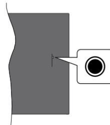
Televizorul dvs. are un buton de control unic. Acest buton vă permite să controlați funcțiile Intrări / Volum sus-jos / Canal sus-jos / Pornire-oprire / ieșire ale televizorului.
