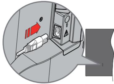
Dugja be a mellékelt levehető tápkábel egyik végét (kélyukú dugót) a TV hátlján lévő tápkábel bemenetébe, a fent látható módon. Ezután dugja be a tápkábel másik végét a hálózati aljzatba. Ezután a TV készenléti üzemmódba kapcsol.
