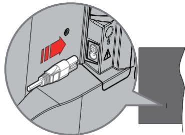
Conectați un capăt (mufa cu două orificii) a cablului de alimentare detașabil în contactul de intrare pentru cablu de alimentare din spatele televizorului, așa cum este prezentat mai sus. Apoi conectați stăcherul la priza de rețea. Televizorul se va comuta în modul standby.
