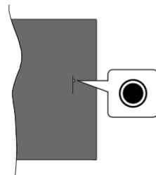
Uw TV heeft een enkele bedieningstoets. Deze knop biedt u de mogelijkheid de Ingangen / Volume omhoog-omlaag / Programma omhoog-omlaag / Stroom aan/uit / Afsluiffuncties te bedienen van de TV.
