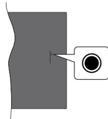
Вашият телевизор има единичен контролен бутон. Този бутон ви позволява да контролирате функциите Входове / Сила на звука нагоре-надолу / Канал нагоре-надолу / Включване-изключване / Изход на телевизора.
