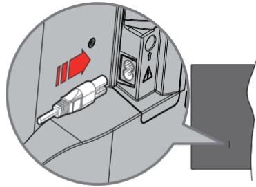
Jeden koniec (zástrčka s dvoma otvormi) dodaného odpojiteľného napájacieho kábla zapojte do zásuvky pre napájací kábel na zadnej strane televízora, ako je to znázornené vyššie. Potom zapojte druhý koniec napájacieho kábla do sieťovej zásuvky. Televízor sa prepne pre pohotovostného režimu.
