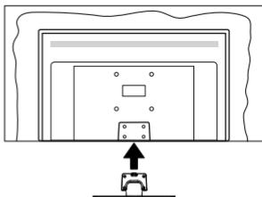
3. Helyezze be a mellékelt csavarokat és óvatosan húzza meg őket (M4 x 12 mm), amíg az állvány megfelelően rögzül.
