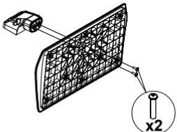
2. Τοποθετήστε τη βάση (τις βάσεις) πάνω στο σχέδιο (στα σχέδια) στερέωσης βάσης στην πίσω πλευρά της τηλεόρασης.
