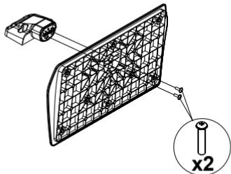
2. Stojan (y) umístěte na schéma montáže stojanu(ú) na zadní straně televizoru.
