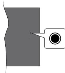
Váš televízor má jediné ovládacie tlačidlo. Týmto tlačidlom môžete ovládať funkcie **Vstupy** / **Zvyšovanie a znižovanie hlasitosti** / **Zvyšovanie a znižovanie kanálov** / **Zapnutie a vypnutie** / **Ukončenie** televízora.
