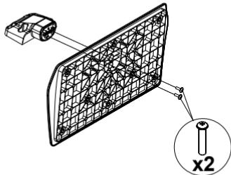
2. Stojan(y) umiestnite na schému montáže stojana(ov) na zadnej strane TV.
