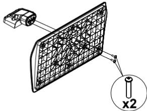
2. Colocar o suporte(s) no encaixe(s) de montagem na parte de trás da TV.
