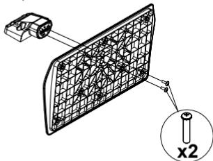
2. Așezați suportul (suporturile) pe structura (structurile) de montare a suportului pe partea din spate a televizorului.
