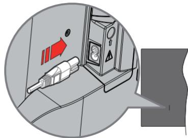
Voer een uiteinde (de stekker met twee openingen) van het geleverde verwijderbare netsnoer in de netsnoer inlaat van de TV zoals hierboven weergegeven. Over daarna het andere uiteinde van het netsnoer in het stopcontact. De TV schakelt nu over op de stand-bymodus.
