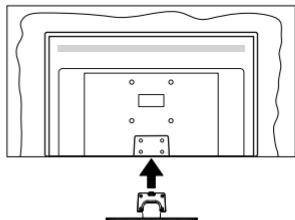
3. Umieść dołączone do zestawu śruby (M4 x 12 mm) i dokręć je delikatnie, aby poprawnie umocować stojak.
