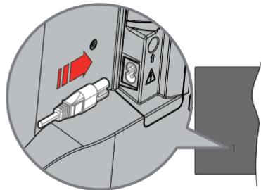
Включете единия край (щепсела с два отвора) на предоставения разглобяем захранващ кабел във входа за захранващ кабел на задната страна на телевизора, както е показано по-горе. След това включете другия край на захранващия кабел в контакта. Телевизорът ще премине в режим на готовност.
