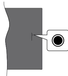
Telewizor jest wyposażony w jeden przycisk sterowania. Ten przycisk umożliwia sterowanie funkcjami wejść/zwiększenia i zmniejszania głośności/przełączania na następny/poprzedni kanał/włączania-wyłączania/wyjściem z funkcji telewizora.
