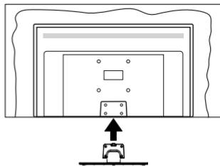
3. Introduceți șuruburile (M4 x 12 mm) furnizate și strângeți-le ușor până când suportul este montat corect.
