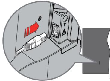
Podłącz jeden koniec (dwuotworową wtyczkę) dostarczonego odłączanego przewodu zasilającego do wejścia przewodu zasilającego z tyłu telewizora, jak pokazano powyżej. Następnie podłącz drugi koniec przewodu zasilającego do gniazdkła. TV przełączy się w tryb gotowości.
