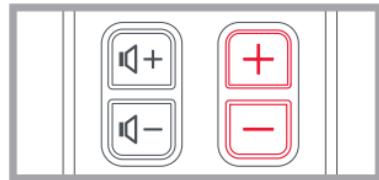
**3.** Ange den första femsiffriga koden som listats för ditt fabrikat med tangenterna för ström, kanal och volym för att representera siffrorna. (t.ex. 21656 för Sony).
