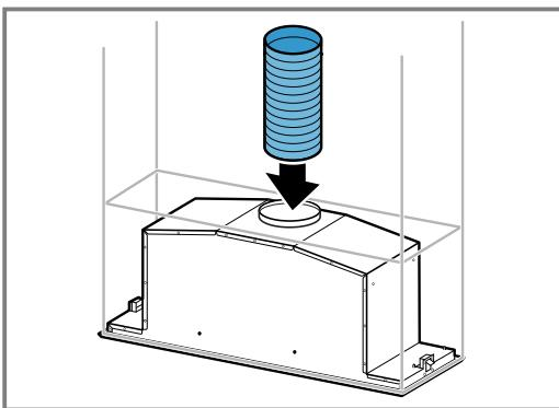
2. De verbinding met de afvoerluchtopening maken.
