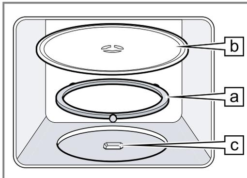
2. Incastrare il piatto girevole **b** nell'elemento di trasmissione **c** che si trova al centro del fondo del vano di cottura.
