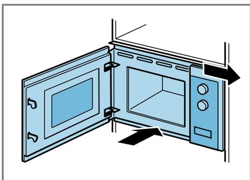
**3. Visser l'appareil jusqu'à ce qu'il soit centré.**
