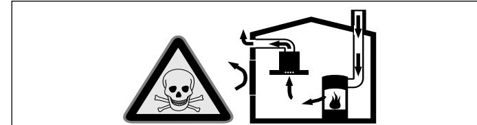
Raumluftabhängige Feuerstätten (z.B. gas-, öl-, holz- oder kohlebetriebene Heizgeräte, Durchlauferhitzer, Warmwasserbereiter) beziehen Verbrennungsluft aus dem Aufstellraum und führen die Abgase durch eine Abgasanlage (z.B. Kamin) ins Freie.
