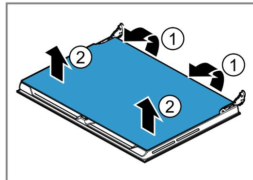
5. Déposez la vitre intérieure et placez-la avec précaution sur une surface plane.
