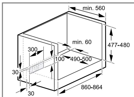
Pour la ventilation de l'appareil, le plancher intermédiaire doit présenter une découpe de ventilation.
