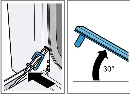
De apparaatdeur niet volledig sluiten. De scharnieren kunnen verbogen worden en er kan schade aan het email ontstaan.
