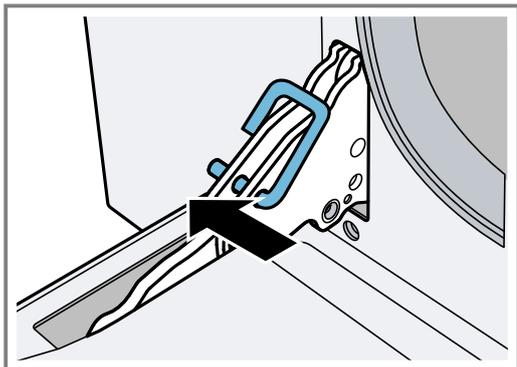
De veiligheidspennen dienen volledig in de gaten van de scharnieren gestoken te zijn.
