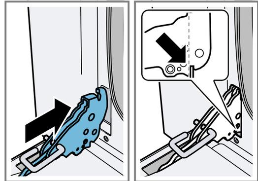
De keep aan de onderkant van de scharnieren moet inklikken in de omlijsting van het apparaat.
