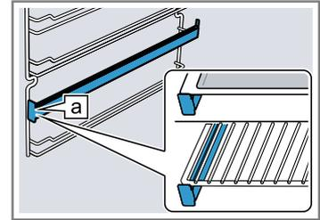
**Nota:** Una volta estratte del tutto, le guide di estrazione si innestano. Spingere indietro con una leggera pressione le guide di estrazione nel vano cottura.
