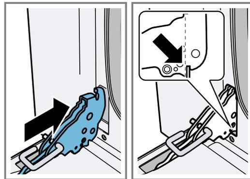
Die Kerbe unten an den Scharnieren muss im Rahmen des Geräts einrasten.
