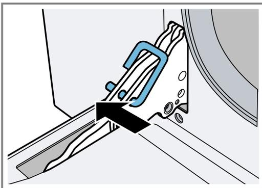
Die Sicherungsstifte müssen vollständig in den Bohrungen der Scharniere stecken.
