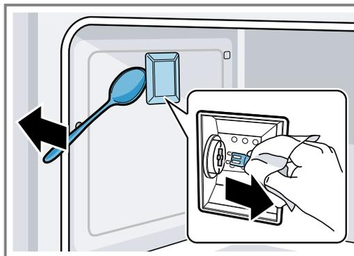
6. Die Garraumlampe durch den gleichen Lampentyp ersetzen.
