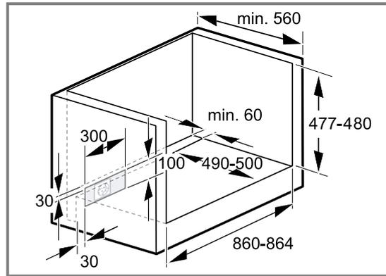
Per la ventilazione dell'apparecchio occorre una fessura di ventilazione nel ripiano intermedio.
