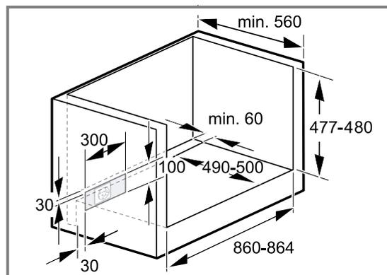
Zur Belüftung des Geräts muss der Zwischenboden einen Lüftungsausschnitt aufweisen.
