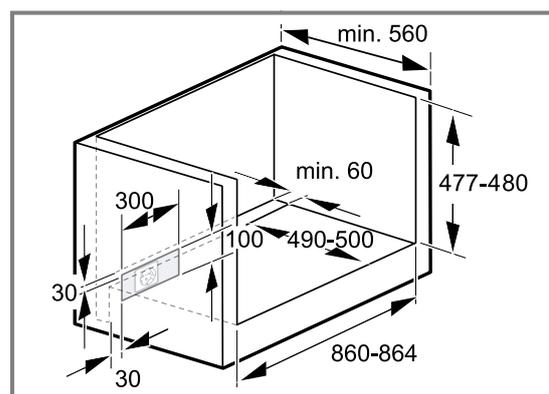
Met het oog op de luchttoevoer van het apparaat dient het tussenschot te beschikken over een ventilatieopening.
