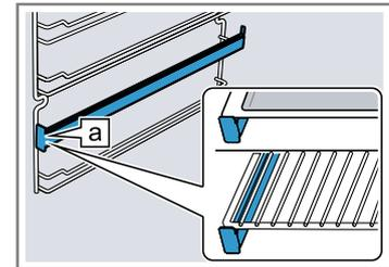
**Remarque :** Lorsqu'ils sont complètement sortis, les rails télescopiques s'enclenchent en place. Repoussez les rails télescopiques dans le compartiment de cuisson en exerçant une légère pression.
