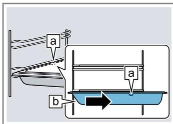
3. Pour poser les accessoires à des niveaux d'enfournement avec les rails télescopiques, sortez ces derniers.
