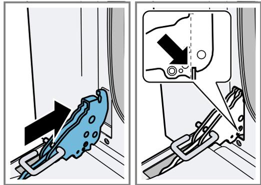
La scanalatura in basso sulle cerniere deve innestarsi nel telaio dell'apparecchio.
