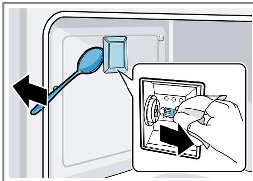
6. De lamp van de binnenruimte vervangen door een lamp van hetzelfde type.
