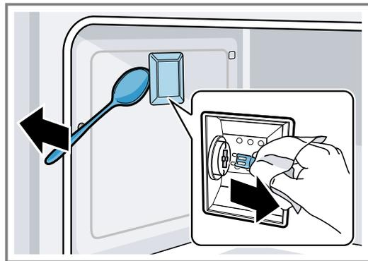
6. Sostituire la lampadina del vano cottura con una dello stesso modello.
