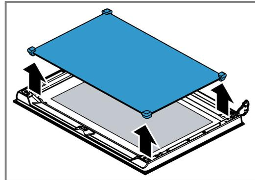
Il pannello intermedio non è fissato con i perni di fissaggio, ma con i cuscinetti in gomma.
