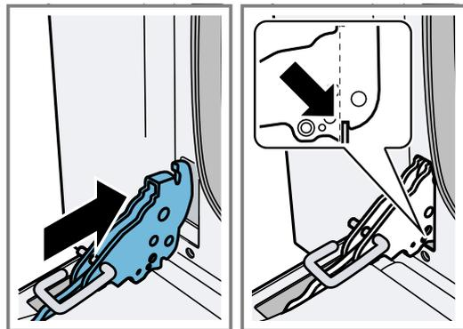
L'encoche en bas aux charnières doit s'enclencher dans le cadre de l'appareil.
