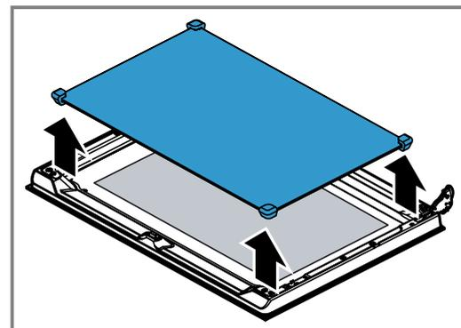
La vitre intermédiaire n'est pas fixée avec des gouilles de retenue, mais est fixée par des paliers en caoutchouc.
