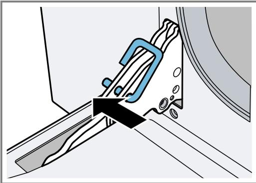
Le spine di sicurezza devono inserirsi completamente nei fori delle cerniere.
