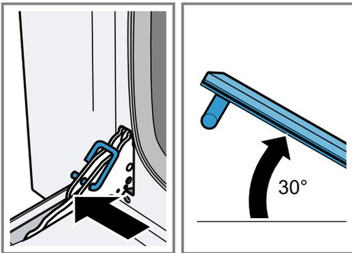
Die Gerätetür nicht vollständig schließen. Die Scharniere können verbogen werden und es können Emailschäden entstehen.
