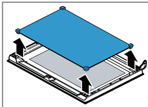
De tussenruit is niet met bevestigingspennen bevestigd, maar door een rubberen lager.
