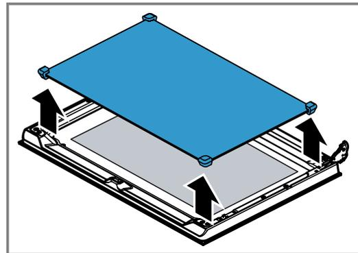
Die Zwischenscheibe ist nicht mit Haltestiften befestigt, sondern ist durch Gummilager befestigt.
