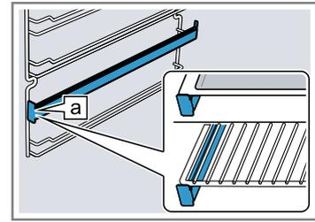
**Opmerking:** Volledig uitgetrokken klikken de telescooprails in. De telescooprails met een lichte druk terugschuiven in de binnenruimte.
